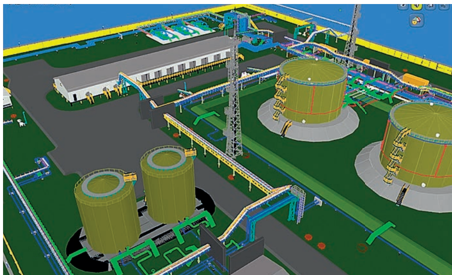
Рис. 4. Первичная раскладка кабелей для определения объема полок
